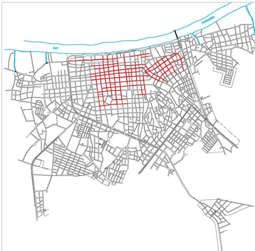
FIGURA 10.2 – REDE DE DISTRIBUIÇÃO COM TUBOS DE CIMENTO AMIANTO
